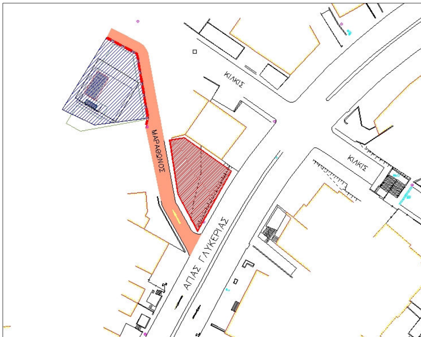
Σχήμα 3.8.2. Φρέαρ εξαερισμού Σταθμού «Ελικώνος» – Κυκλοφοριακές Ρυθμίσεις κατά τη διάρκεια της κατασκευής
